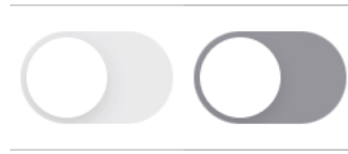
Abbildung 6: Beim linken Toggle-Button hat die hellgraue Fläche zum weißen Hintergrund sowie zur Button-Fläche einen sehr schwachen Kontrast von 1,2 zu 1. Der rechte Toggle-Button mit dem dunkleren Grau erfüllt das Minimum von 3 zu 1. Quelle: iOS Systemeinstellungen / Abruf im April 2021
